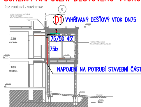
SCHÉMA NAPOJENÍ DEŠŤOVÉHO VTKU
