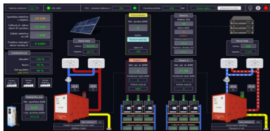
Obrázek 21 – Operátorská úroveň řídicího systému
