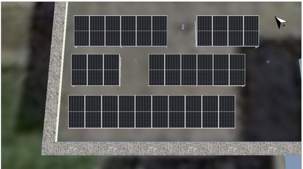
Obrázek: 1. Umístění modulů - Pavilon Ř-parc.č.563/15-Montážní plocha Severovýchod
